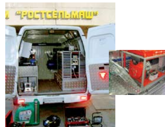
Передвижная мастерская для обслуживания сельскохозяйственной, дорожно-строительной и коммунальной техники.
