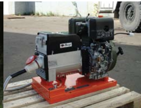
Электроагрегат АДП4,2-230ВЛ-С для поддержания температуры воды в системе охлаждения неработающего двигателя локомотива в заданных пределах
