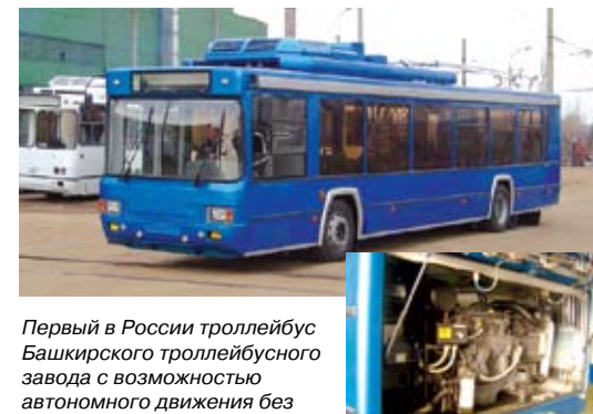
Установка электроагрегата АДС (двигатель DEUTZ + генератор SINCRO) Р- 120kW, напряжение 650 В постоянного тока на троллейбусе.
