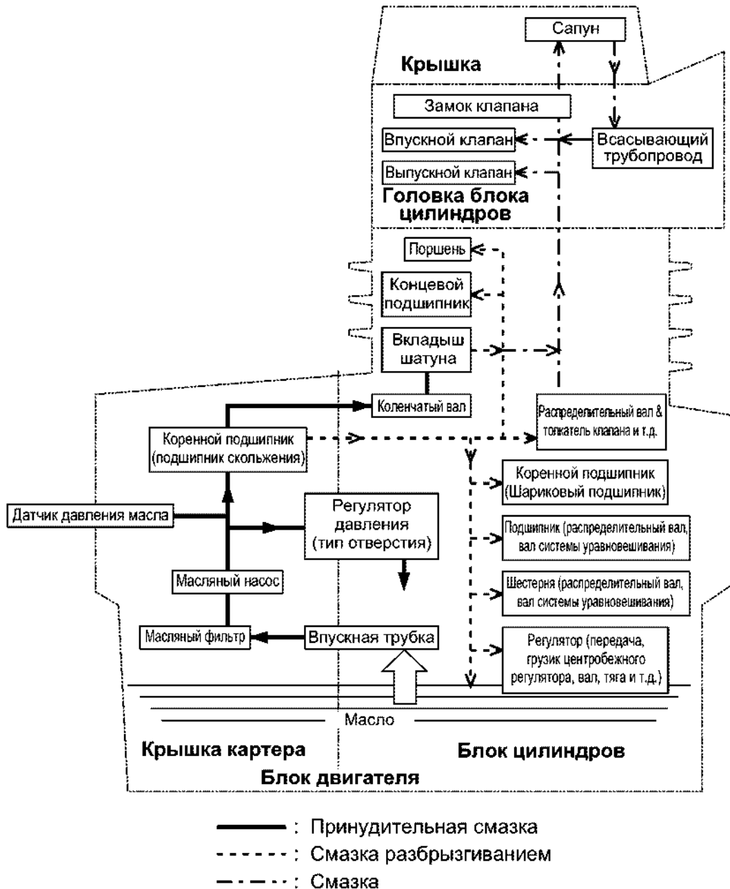
Рис. 76 Схема циркуляции масла
