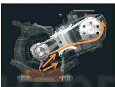
Масло переносится цепью к верхнему распределительному валу и клапанному механизму. Дозировка масла осуществляется системой, расположенной в крышке клапанного механизма, на которую также подана патентная заявка.
