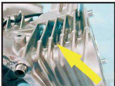
Воздух обдувает большие склонные охлаждающие ребра на блоке цилиндров, обеспечивая эффективное охлаждение. На данную систему подана патентная заявка.
