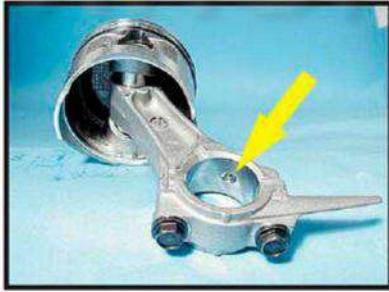
Шатун в двигателях Honda имеет одно стандартное смазывающее отверстие на шатуне.
