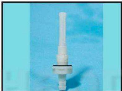
Топливный фильтр двигателей Robin Subaru EX в два раза больше фильтра двигателей Honda. На заливной горловине топливного бака установлена фильтрующая сетка, а на впуске карбюратора – полупрозрачный отстойник.
