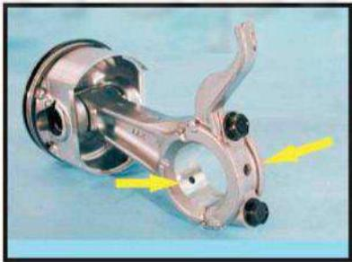
Масло подается к шатунной шейке коленчатого вала через два смазочных отверстия в шатуне. Диаметр шейки рассчитан на большой поток масла.
