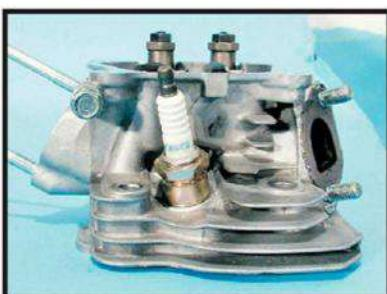
Конструкция двигателей Honda с верхним расположением клапанов не предусматривает охлаждение зон вокруг клапанных штоков. Температура блока головки цилиндра выше.
