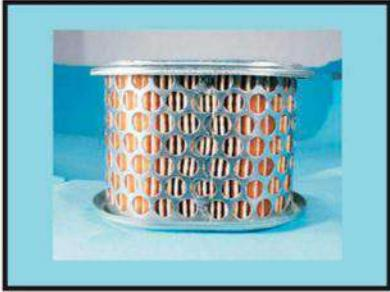
В двигателях Honda используется качественная двухступенчатая система очистки воздуха.
