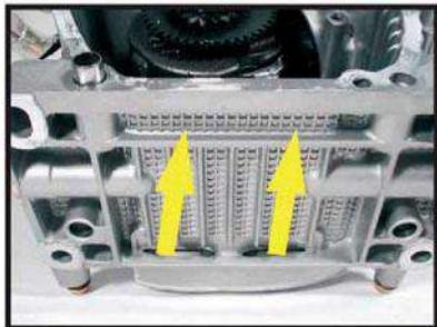
Уникальная система охлаждения двигателей Robin Subaru действует также и под основанием двигателя. Воздушный поток обдувает специальные охлаждающие ребра на нижней стороне двигателя для его максимального охлаждения.
