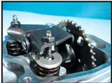
Для увеличения долговечности и уменьшения потребности в обслуживании в двигателе применяются клапанные коромысла из закаленной стали с устройством точной регулировки тарелок клапанов.
