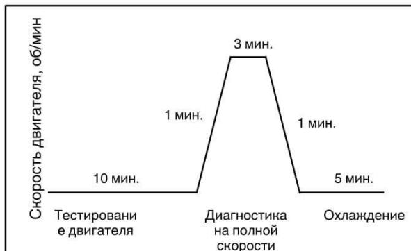
Рис. 2-1 Цикл тестирования без нагрузки
