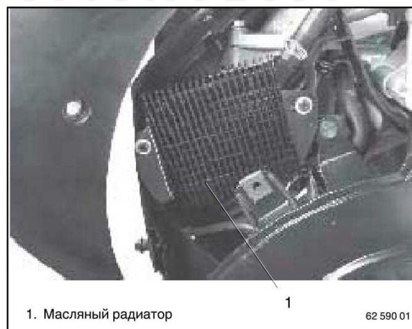
**Рис. 5-3** Место установки масляного радиатора
