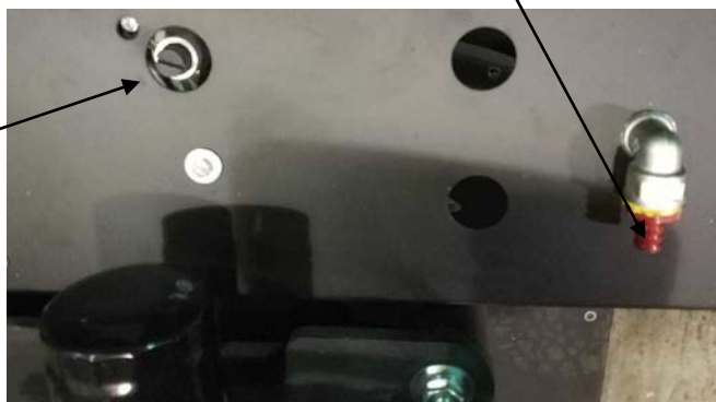
При выборе газа, обратите внимание какого цвета стоит штуцер дозирования, замените при необходимости штуцер: желтый-метан; красный- пропан/бутан
