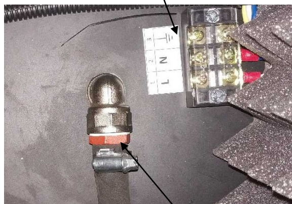
При выборе газа, обратите внимание какого цвета стоит штуцер дозирования, замените при необходимости штуцер: желтый-метан; красный- пропан/бутан
