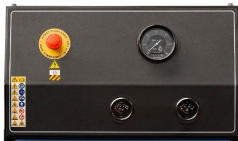
**Пульт M80** имеет двойное назначение. Он служит обычной контактной платой для соединения электрошкафа и щитка приборов, чьи инструменты позволяют отслеживать основные параметры электроагрегата.
