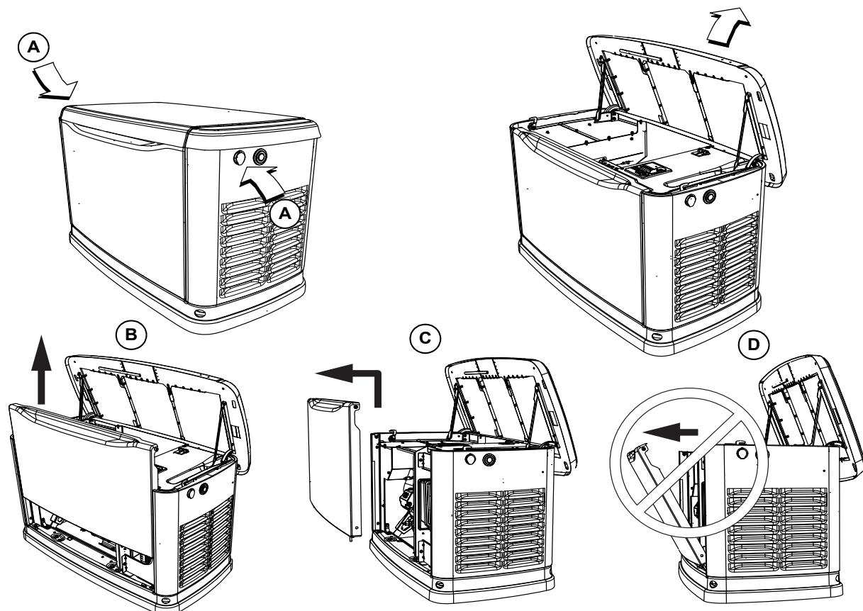
*Рис. 3–1. Место бокового замка и снятие передней панели*
