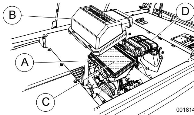
**Рис. 4-3. Обслуживание воздухоочистителя**
