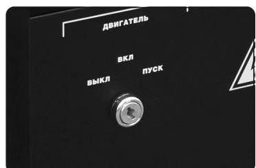
(c) Установите выключатель в положение «ВЫКЛ».
