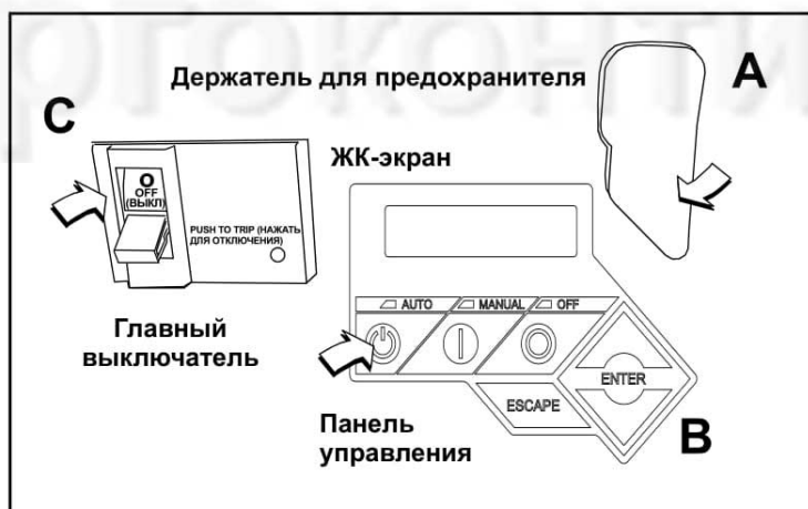
Рис. 5-16. Панель управления генератора
